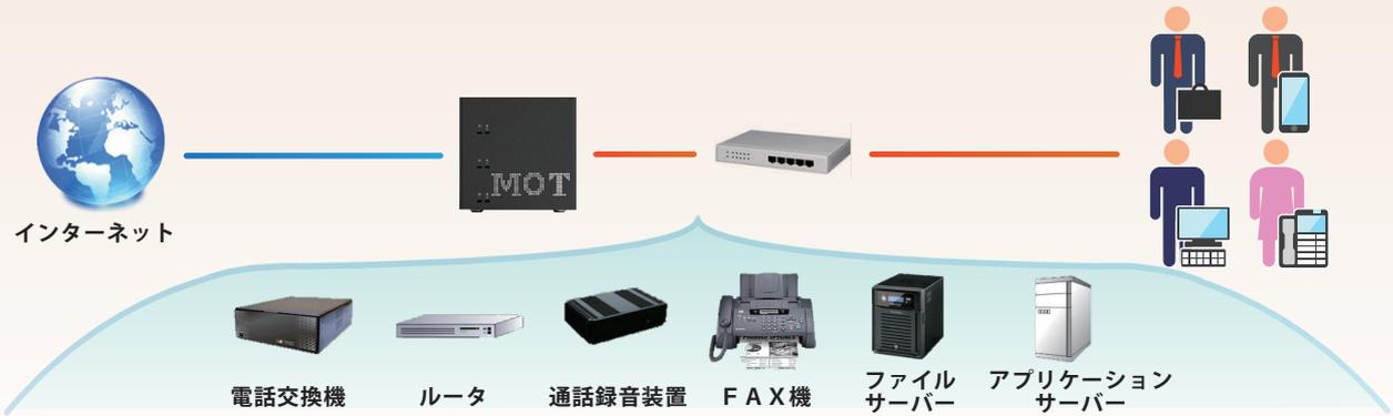
今までは、別々に購入していた、電話交換機、ルータ、通話録音装置、FAX 機、ファイルサーバ、アプリケーションサーバを、MOT/Server1 台に集約。次世代電話交換機のスマートフォン連動機能に加え、音声通話の自動録音、注文等の FAX データの管理や保存、業務用アプリケーションの運用サーバ、業務データのバックアップ。これらを MOT/Server 1 台だけで実現することができます。
